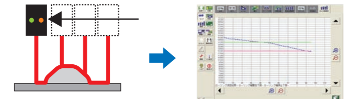
Mesure la largeur du dépôt de pâte à braser
