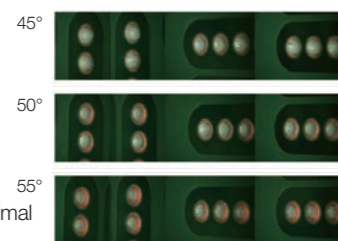
Effets du nettoyage et quantité estimée de crème à braser : Une meilleure sérigraphie grâce à la fonction de réglage de l'angle de la racle.
